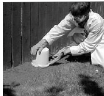
Figura 3: La cámara de aire es un cubo plástico de 5 litros que se coloca sobre el captador y se introduce dentro del suelo a una profundidad de 2 cm. Derecha: El suelo que rodea esta cámara se presiona a lo largo de los bordes del cubo para que quede bien sellado.
