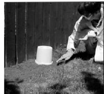
Figura 3: La cámara de aire es un cubo plástico de 5 litros que se coloca sobre el captador y se introduce dentro del suelo a una profundidad de 2 cm. Derecha: El suelo que rodea esta cámara se presiona a lo largo de los bordes del cubo para que quede bien sellado.
