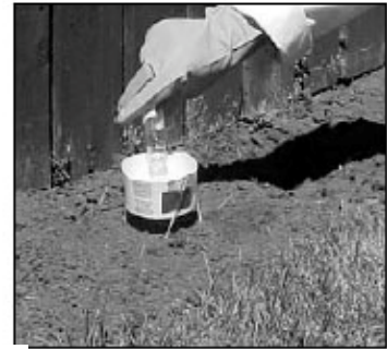
Figura 2: Se transporta el NaOH al lugar de estudio en un frasco de cristal y luego se vierte dentro del captador.
