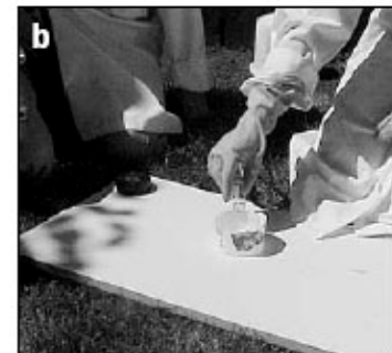
Figura 3: La cámara de aire es un cubo plástico de 5 litros que se coloca sobre el captador y se introduce dentro del suelo a una profundidad de 2 cm. Derecha: El suelo que rodea esta cámara se presiona a lo largo de los bordes del cubo para que quede bien sellado.
