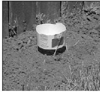
Figura 1: Un recipiente de plástico cortado a una altura de aproximadamente 4 cm sirve como captador de NaOH. Se suspende encima del suelo sobre un trípode hecho con tres palillos pegados al recipiente.
