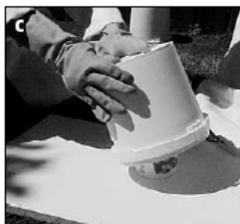
Figura 4: Instalación del control. a) El captador de NaOH se coloca directamente sobre un tablero plano. b) Se vierten en él 25 ml de NaOH. c) La cámara de aire se coloca sobre el captador. d) Se sella esta cámara al tablero usando cinta aislante negra.
