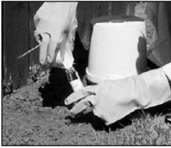
Figura 5: Al final del experimento, se separa la cámara de aire suavemente y se vierte el NaOH en un frasco de cristal para transportarlo al laboratorio.
