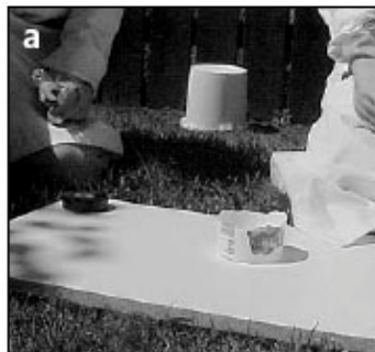
Figura 3: La cámara de aire es un cubo plástico de 5 litros que se coloca sobre el captador y se introduce dentro del suelo a una profundidad de 2 cm. Derecha: El suelo que rodea esta cámara se presiona a lo largo de los bordes del cubo para que quede bien sellado.
