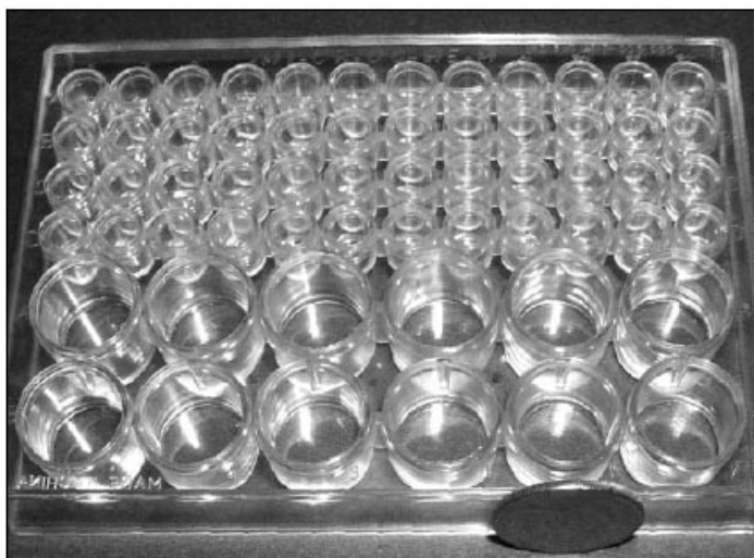
Placa de pocillos para reacciones de combinación diseñada para su uso en institutos.
