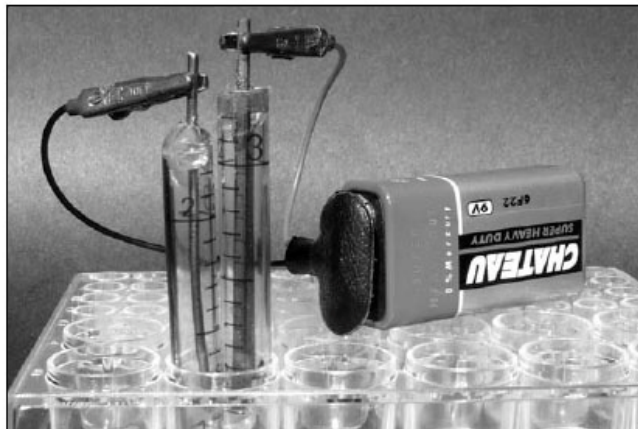
Sencillo montaje para demostrar la electrolisis usando solamente 5 ml de disolución
