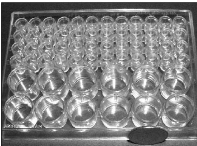
Placa de pocillos para reacciones de combinación diseñada para su uso en
