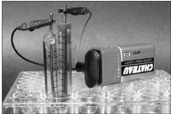
Sencillo montaje para demostrar la electrólisis usando solamente 5ml de disolución
